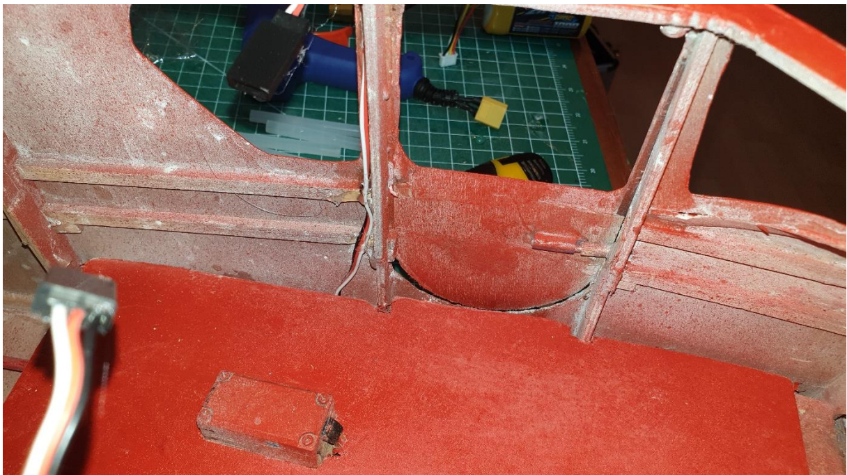
Le plancher est collé en place. Vous noterez les servos installés sous la cabine pour les commandes de profondeur et de dérive. Ils seront masqués par les sièges.
