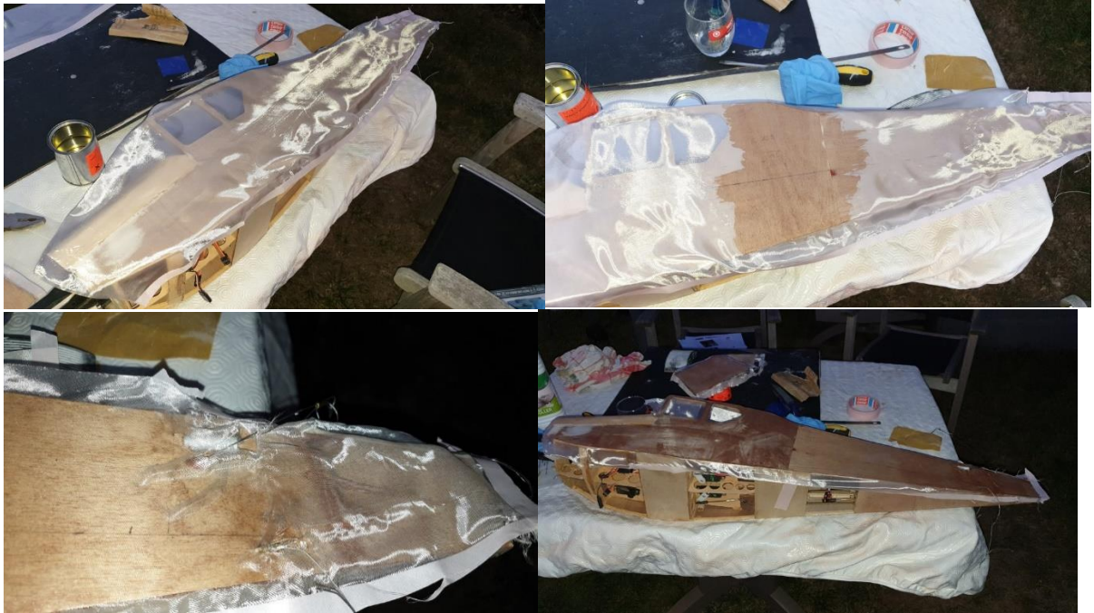
Marouflage du fuselage par pose de coupons de fibre de verre de 25g/m 2 collés et mis en place avec de l'enduit nitrocellulosique
