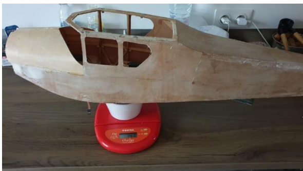
La pesée du fuselage après marouflage, enduit et vernis indique une augmentation de la masse d'environ 5%
