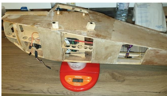
La pesée du fuselage après marouflage, enduit et vernis indique une augmentation de la masse d'environ 5%
