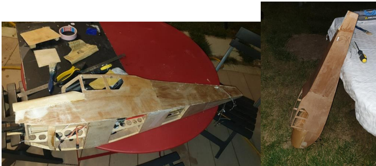
Etat de surface après marouflage à la fibre de verre, passage d'enduit nitrocellulosique et vernis G4. Dommage que vous ne puissiez « voir avec vos doigts », car la surface est lisse et étanche.
