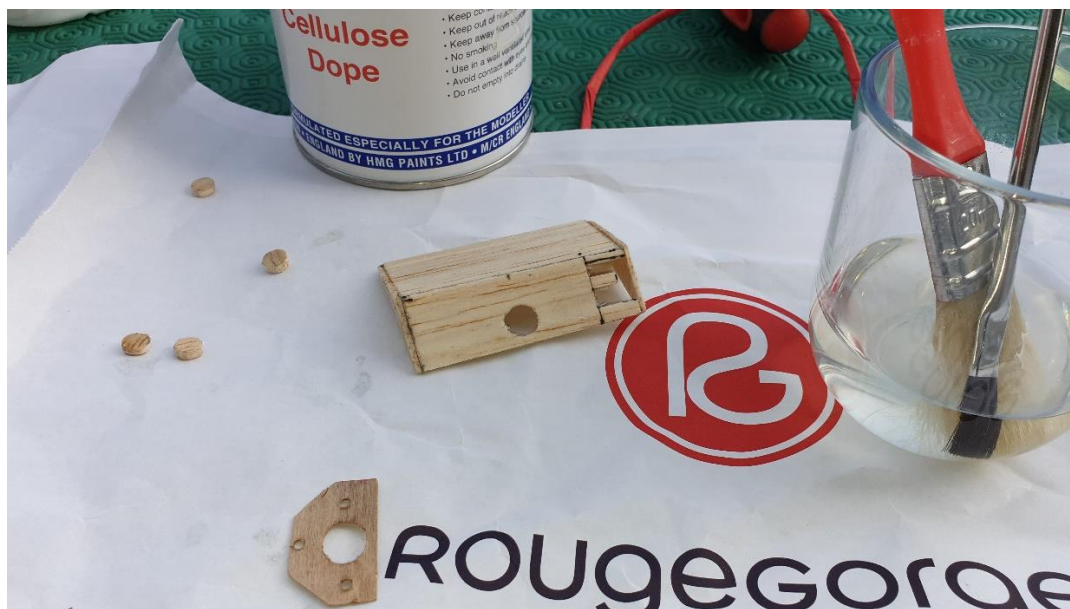
Le coffrage inférieur, la plaque qui sera collée en applique sur le coffrage et les rondelles de balsa pour reproduire les boutons sont découpées dans du balsa et enduit avec de l'enduit nitrocellulosique
