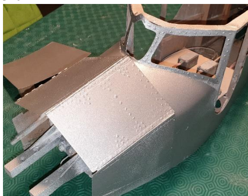
Figure 5 : Les rivets apparaissent dès le passage de l'apprêt avant peinture
