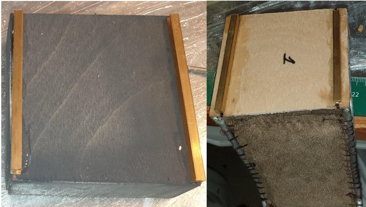
Mise en place des rails d'ajustement sur le coffre et sous l'assise du siège.
