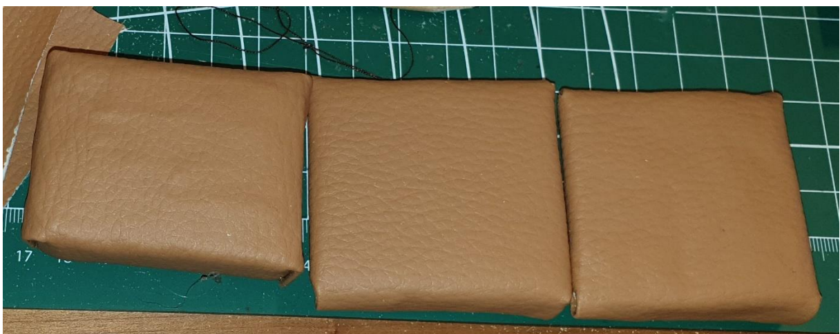
Premier essai de réalisation des assises de sièges avec du skaï collé. Le résultat n'est pas bon, cette solution ne sera pas retenue.
