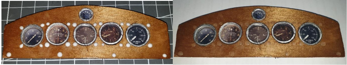
Pose des gouttes de colles pour reproduire les rivets.
