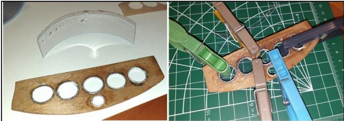
Un morceau de rhodoïd est découpé pour être collé sous la planche de devant. Durant le séchage, le maintien est fait à l'aide de pinces à linge
