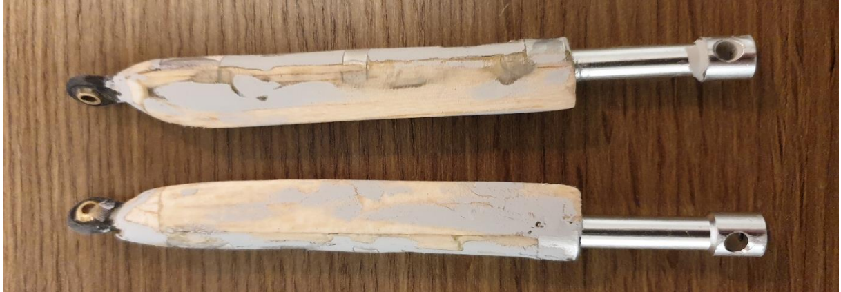
Masticage et ponçage pour obtenir une finition parfaite avant peinture
