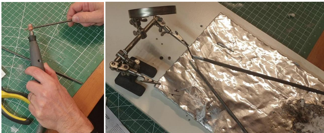
Ponçage de la corde à piano avec une dremel pour enlever la couche de protection et permettre l'adhésion de l'étain. L'axe vertical est maintenu avec une troisième main. Cet axe permettra la fixation de la partie inférieure de la jambe mobile.
