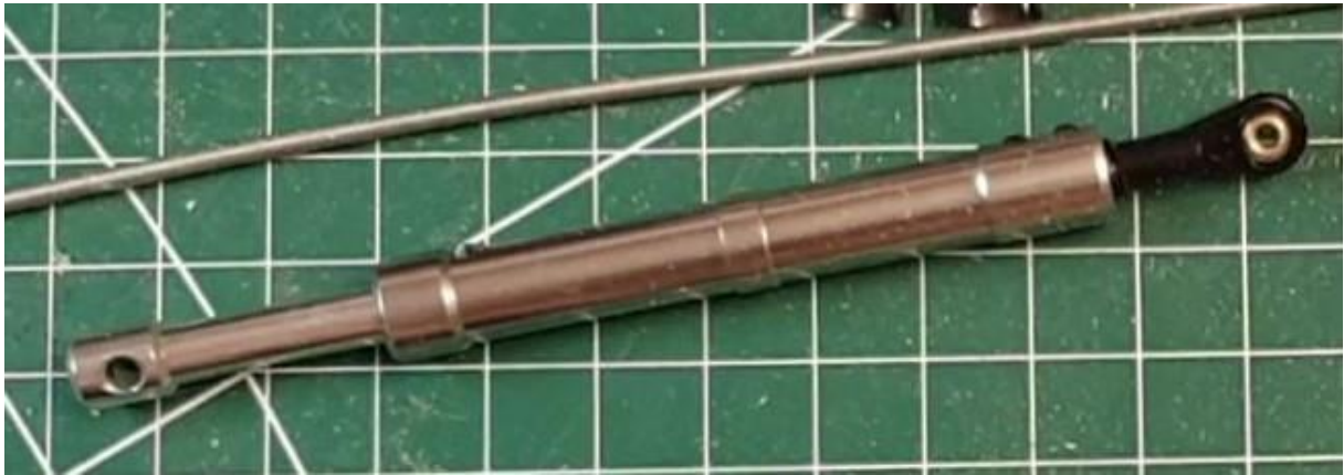
Le système de fixation à la pièce de liaison est en place sur la jambe mobile
