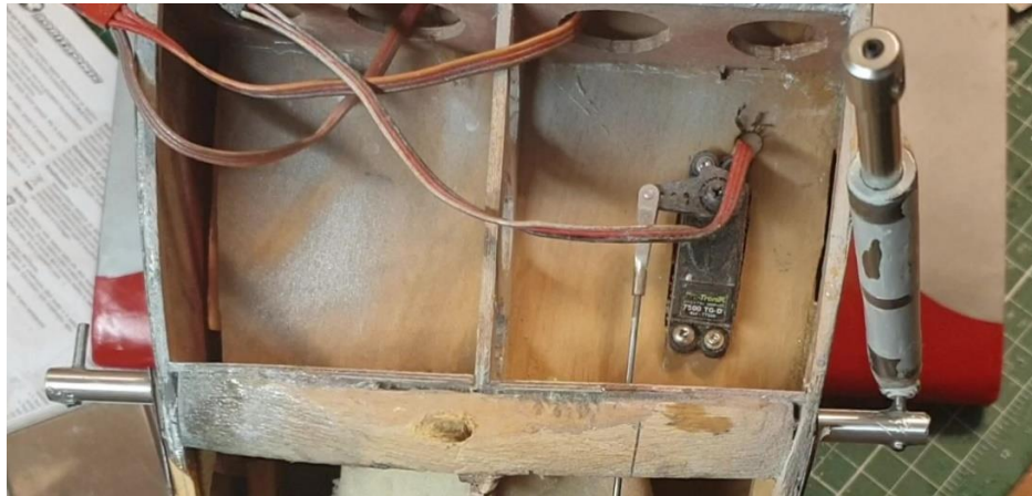
La pièce de liaison est montée sur le fuselage (vue de dessous). Un montage à blanc des axes et de la jambe mobile est fait pour vérifier que tout va bien.
