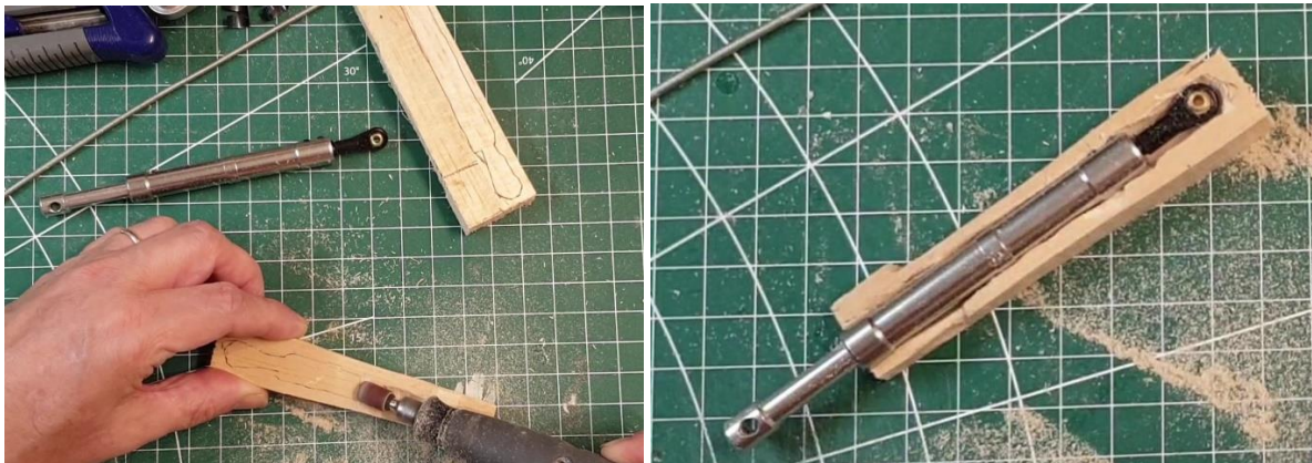
Préparation des blocs de balsa qui vont servir de sarcophage dans lequel la jambe sera placée.
