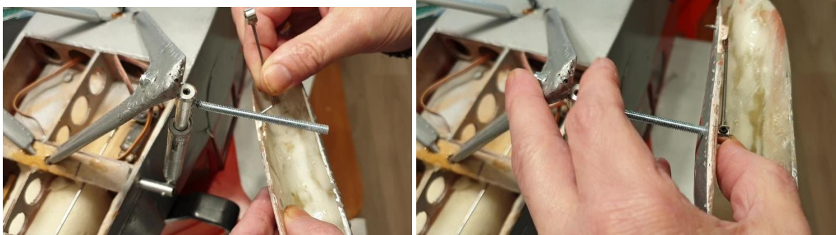
Le carénage est inséré sur la tige filetée. La bague d'arrêt modifiée vient après.
