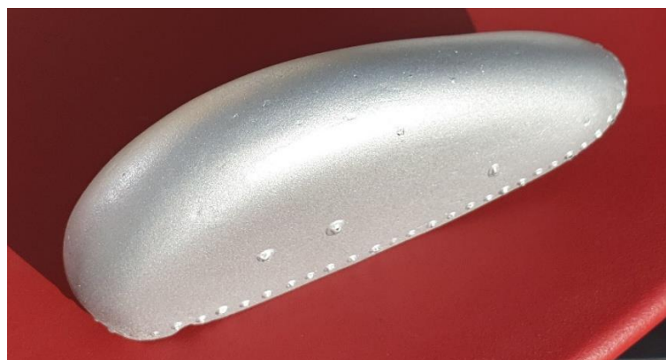
Deux couches de peinture grise sont appliquées sur les carénages
