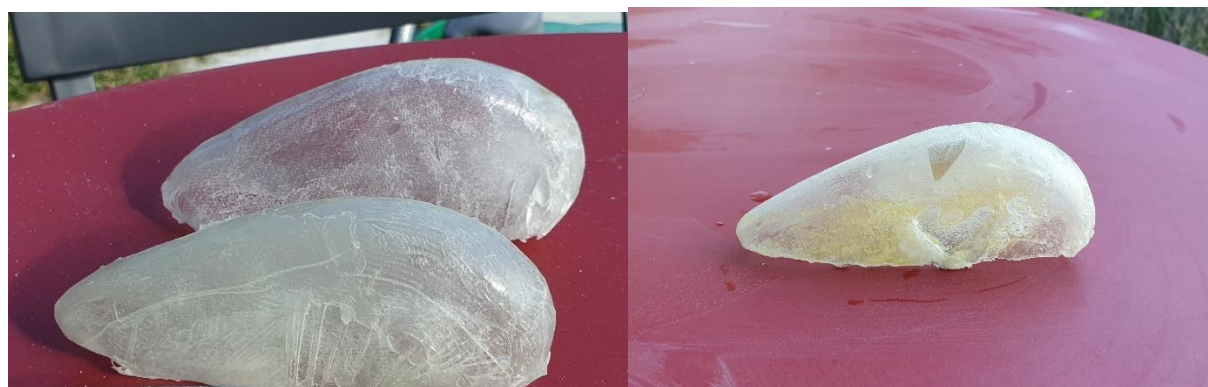
Les carénages sont démoulés après séchage. Ils vont devoir recevoir un traitement de surface pour finition avant peinture
