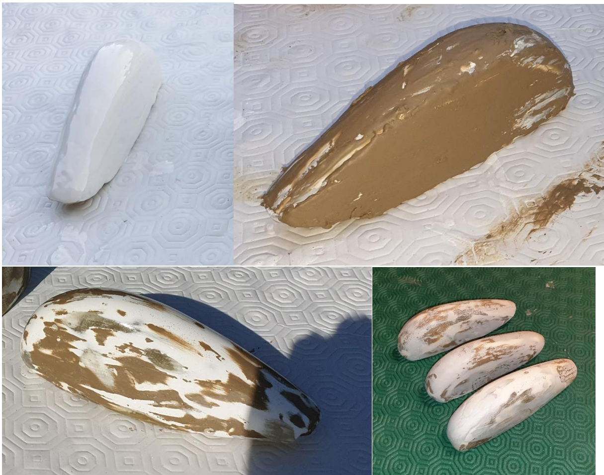
Différents mastics et enduits sont posés sur le carénage en plusieurs couches jusqu'à une finition de surface lisse et sans aspérité au toucher.
