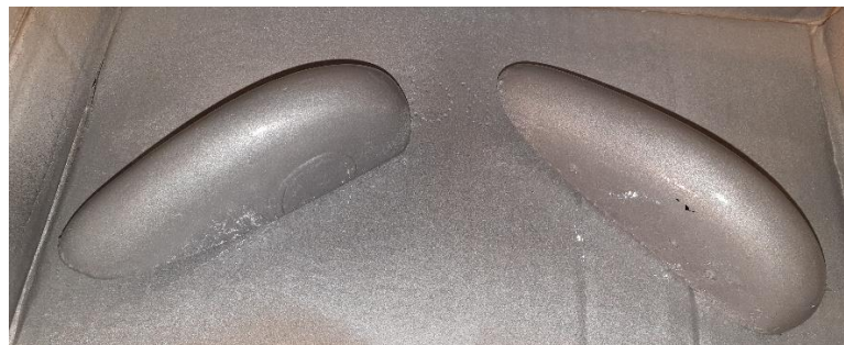
Les carénages sont recouverts avec un enduit avant peinture (filler)
