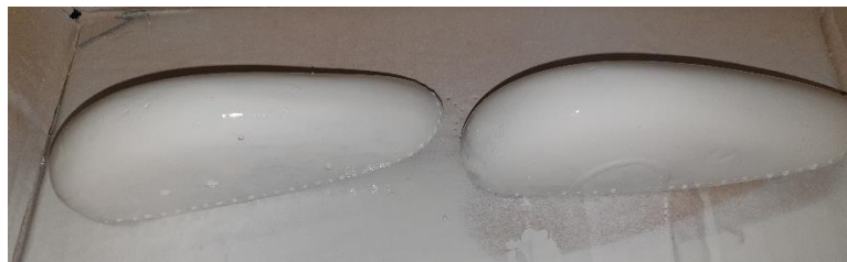
Les carénages sont recouverts avec un enduit avant peinture (filler)
