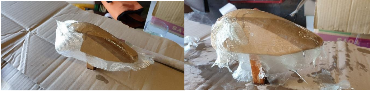
Les coupons de fibre de verre sont posés sur le moule en les imbibant avec de la résine époxy sur le moule.
